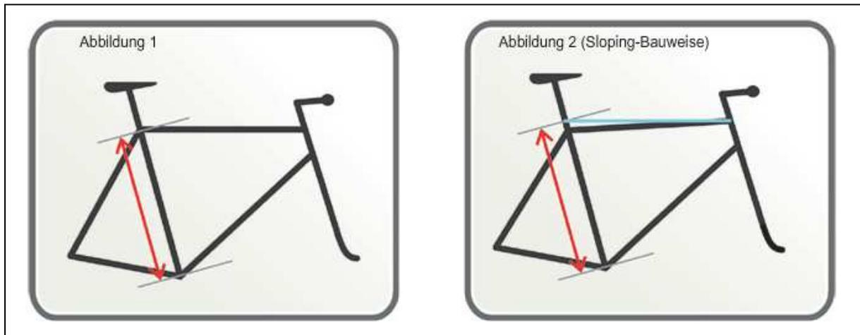
Abb. 5. Messpunkte der Rahmenhöhe
